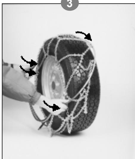
...von oben über den Reifen schieben, bis die **Außenkette** in der Mitte der äußeren Reifenflanke liegt.
