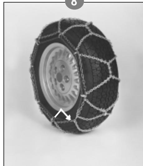
Spannkette zuerst im Bereich der **Reifenlauffläche** kräftig von hinten nach vorne ziehen.
